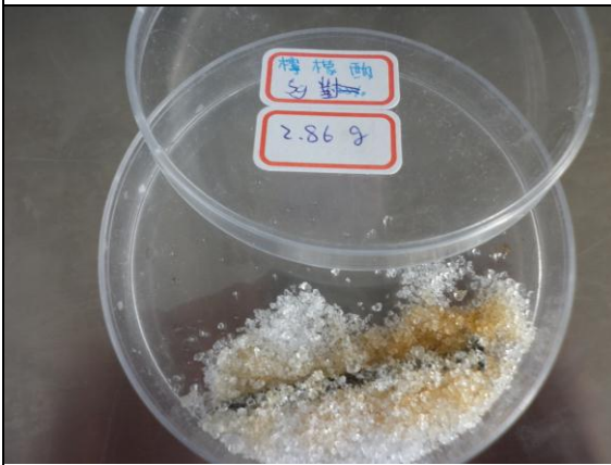
對照組中鐵釘在 5g 檸檬酸中生鏽情況
